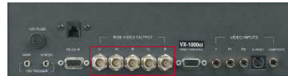
Der PFP Controller nimmt Komponentens-, S-Video- und Composite-Videosignale entgegen und leitet diese nach erforderlichem De-Interlacing/Scaling als RGBHV-Signal an den Projektor weiter
